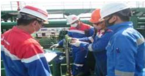
Gambar 1. Pengukuran jumlah muatan dengan alat ukur MMC
