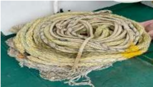
Gambar 7. Kondisi tali sesudah putus (Sumber : Dokumen Pribadi)
