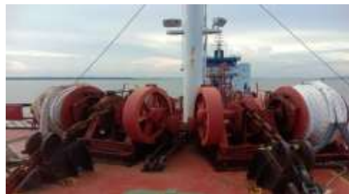
Gambar 4.4. Windlass MT. Anggraini Excellent Sumber : Dokumen pribadi penulis
