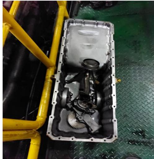
Gambar 4 Bagian oil pump yang di bongkar
