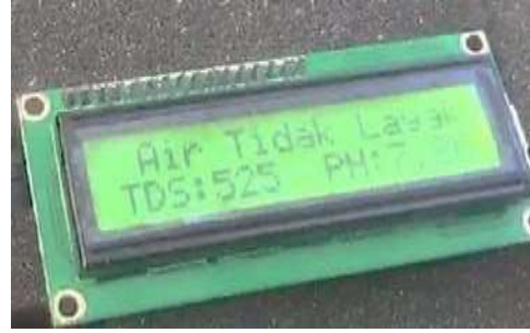
Gambar 4.12 Hasil Uji Coba Variable 3 Air Boiler Sumber : Dokumentasi Pribadi
