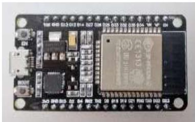
**Gambar 1 Mikrokontroler ESP32**
