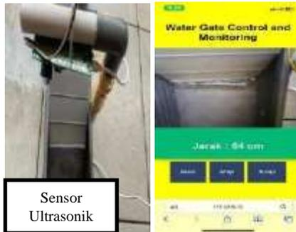
**Gambar 8 Pengujian Sensor Ultrasonik HC-SR04 dan uji ketinggian air dimonitor oleh aplikasi melalui *handphone***
