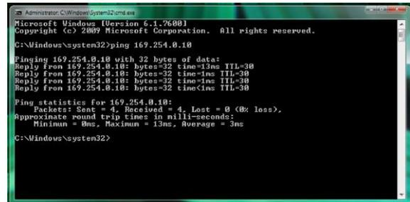
Gambar 4 pengujian dengan ping RTU simulasi
