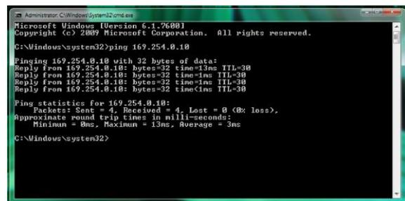
Gambar 5 pengujian dengan ping RTU A
